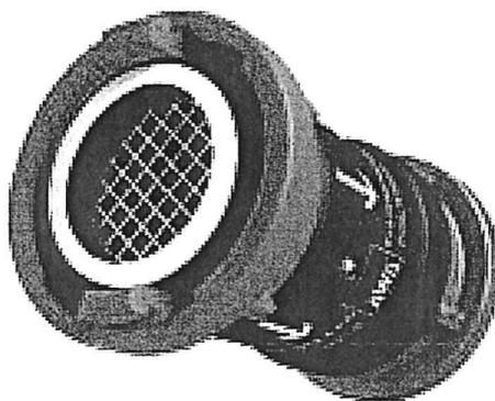
Mobile Systemtrenner für Feuerwehren zur Absicherung des Trinkwasserleitungsnetzes gegen Rücksaugen, Rückfließen oder Rückdrücken von Löschwasser aus Hydranten oder Standrohren. Ein- und ausgangsseitig Rückflussverhinderer, Druckgefälle eingangsseitig mindestens 0,14 bar, Druckverlust < 1 bar, Steinfänger. Ein- und Ausgang Storz B, Eingang drehbar.
