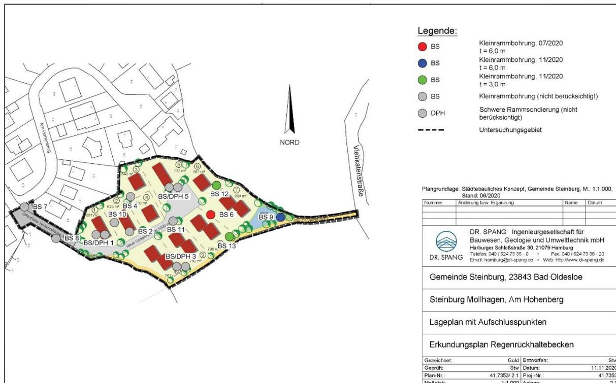
Abbildung 13: Lageplan mit Aufschlusspunkten – Erkundungsplan Regenrückhaltebecken (Dr. Spang Ingenieurgesellschaft für Bauwesen, Geologie und Umwelttechnik mbH)
