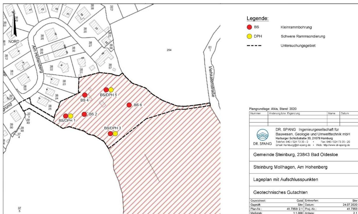
**Abbildung 10: Lageplan mit Aufschlusspunkten – Geotechnisches Gutachten (Dr. Spang Ingenieurgesellschaft für Bauwesen, Geologie und Umwelttechnik mbH) Hinweis: Dargestellter Geltungsbereich bezieht sich auf ehemals konzeptionelle Planung -> ist jedoch für die geotechnische Untersuchung ausreichend**
